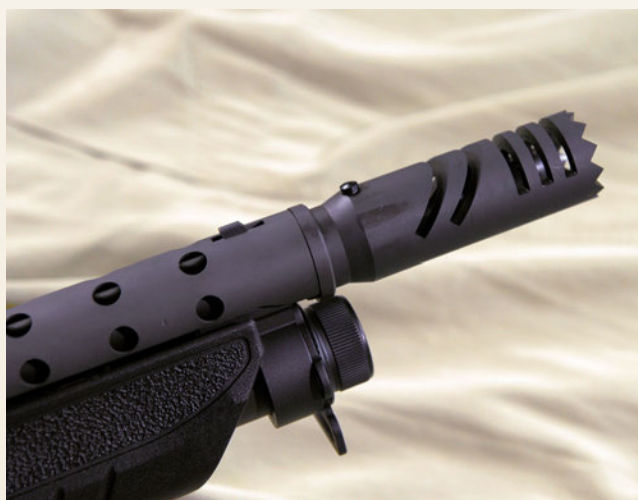
Szczegóły budowy kompensatora – śrubka widoczna na wierzchu służy do stabilizowania kompensatora w prawidłowym ułożeniu względem wzdłużnej osi broni: jeśli zamontujemy go pod złym kątem, zamiast pomagać przy strzelaniu będzie przeszkadzał.
