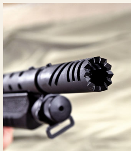
Szczegóły budowy kompensatora – śrubka widoczna na wierzchu służy do stabilizowania kompensatora w prawidłowym ułożeniu względem wzdłużnej osi broni: jeśli zamontujemy go pod złym kątem, zamiast pomagać przy strzelaniu będzie przeszkadzał.
