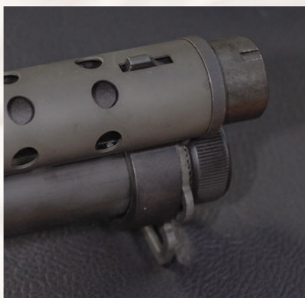
Muszka Fabarma SDASS Martial jest trochę nietypowa, jak na strzelbę – i, niestety, słabo widoczna; dobrym rozwiązaniem jest podmalowanie jej specjalną, fluorescencyjną farbą.
