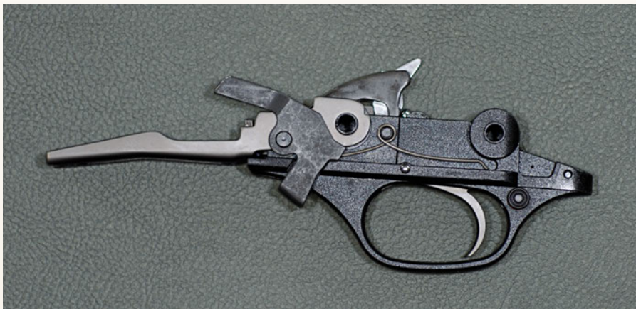
Moduł zespołu spustowo-uderzeniowego, zmontowany na plastikowej podstawie, można rozmontować na drobne elementy, ale wymaga to sporej sprawności manualnej
